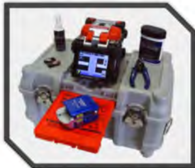
Fusionadora: Óptica Fiber Fusión Splicer Modelo: Type-Q101-CA S/N: 004938245010 Marca: SUMITOMO
